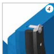
4 Применение болтов с потайной головкой позволяет произвести оперативную замену седлового уплотнения без снятия затвора с трубопровода.
