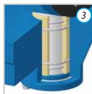
3 Отсутствие протечек по верхнему и нижнему штоку за счет использования не менее 4-х уплотнительных O-колец.
